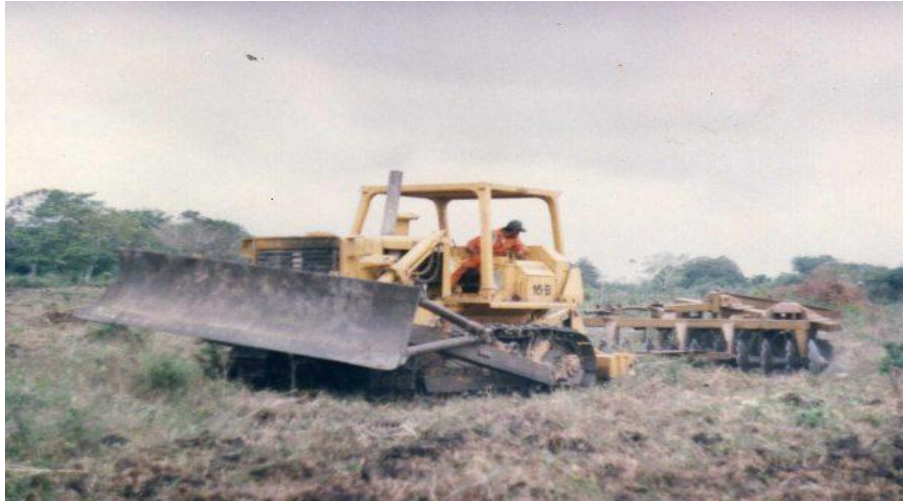
Fig. 2 Rastreo con maquinaria con rastra de tiro semipesada de 20 discos dentados.
