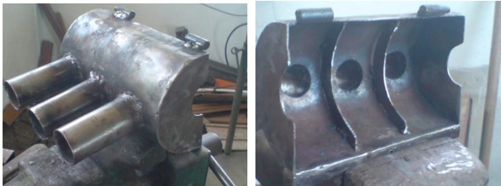
Figura 4.8. Fabricación de la cubierta inferior.
