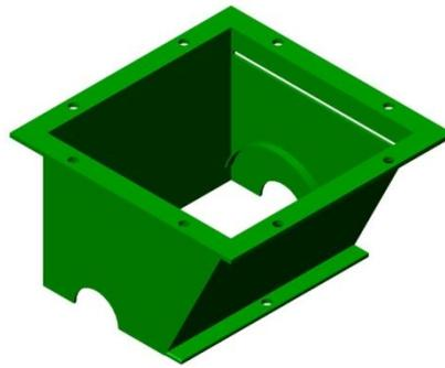
Figura 4.4. Parte superior del dosificador.
