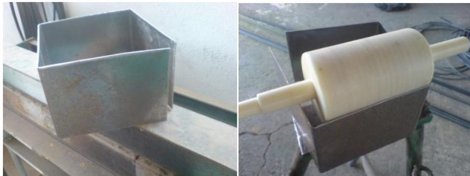
Figura 4.5. Fabricación de la cubierta superior del dosificador.
