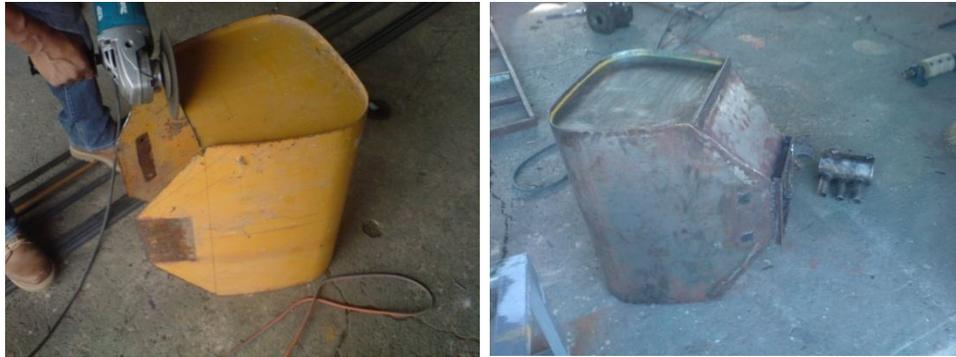
Figura 4.10. Modificación y fabricación de la tolva.
