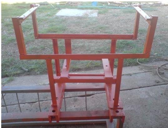
Figura 4.12. Ensamblado del chasis.
