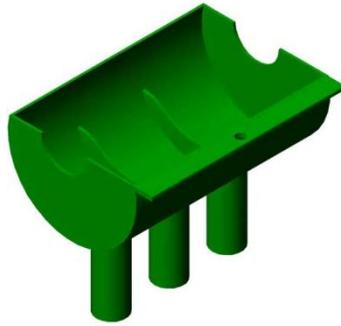
Figura 4.7. Cubierta inferior del dosificador.
