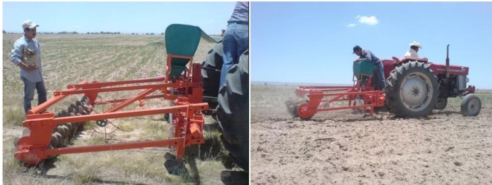
Figura 4.15. Sembradora montada en el cuadro de captación de lluvias *in situ* (aqueel).
