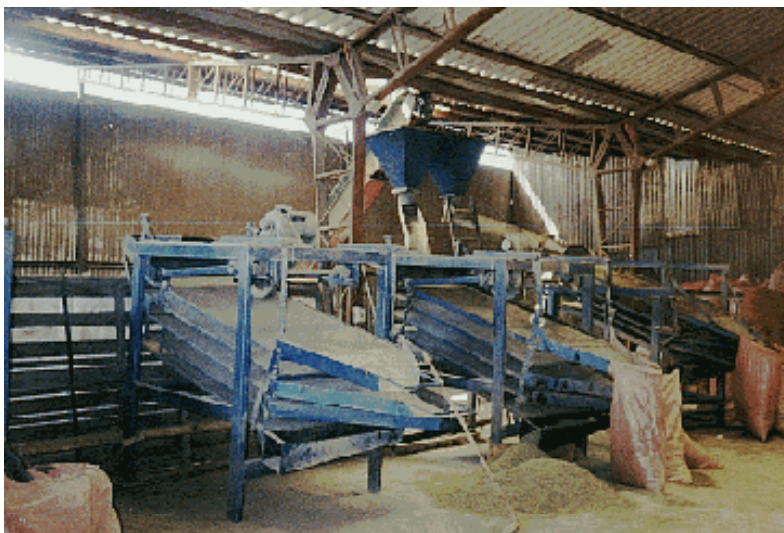
Figura 2.3 Sistema de limpieza con cribas en paralelo ( http://oreganochileno.galeon.com/ ).
