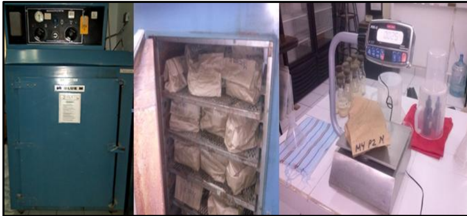
Figura 3.- Estufa de calentamiento de aire forzado, Bascula de 10 kg Material del Laboratorio de Ecología de los Recursos Naturales. RNR-UAAAN.
