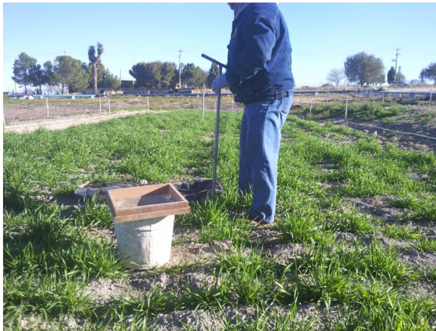
Figura 3.2 Barrenamiento en el centro de las unidades experimentales para la instalación de tubos de acceso para la sonda del aspersionador de neutrones.
