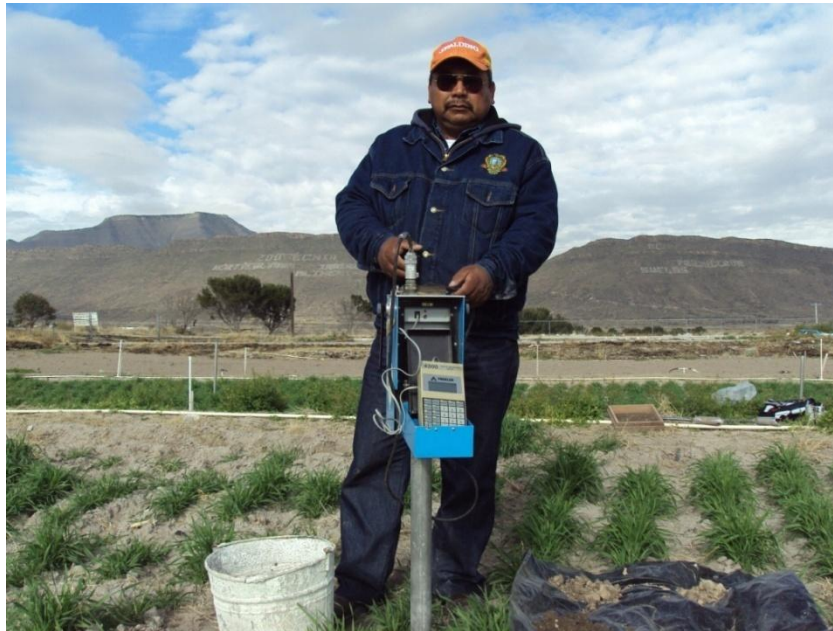
Figura 3.4 Medición del contenido de humedad por el método del aspensor de neutrones.
