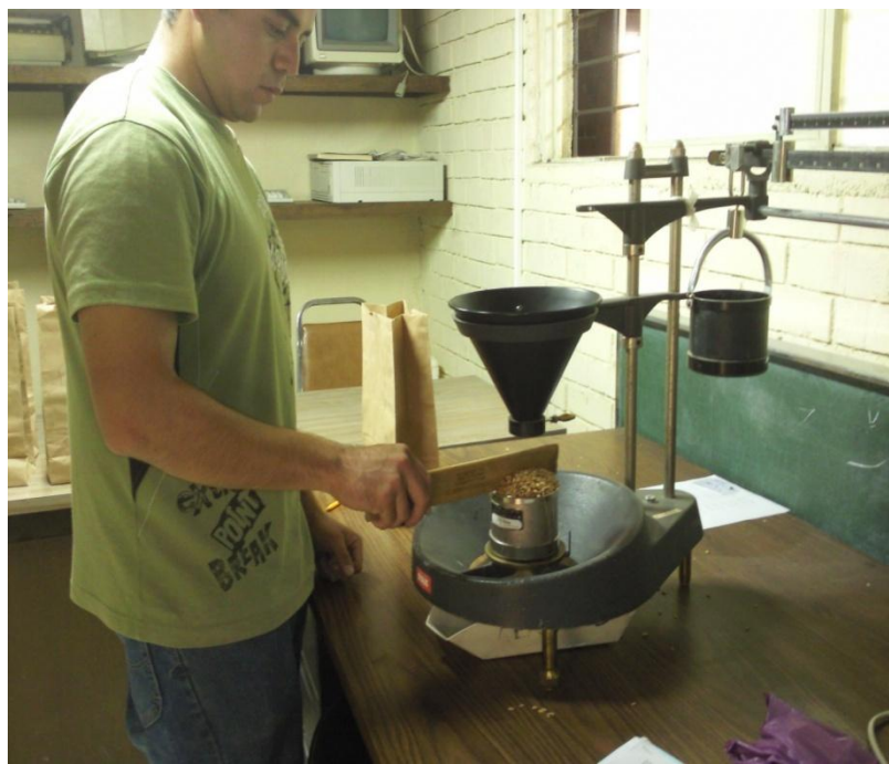
Figura 3.6 Determinación del peso hectolítrico para las 6 repeticiones de cada tratamiento, con la balanzas especial para esta variable medida.
