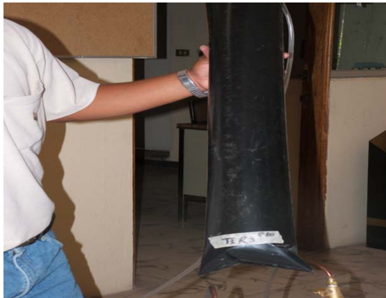
Figura No. 20. Bolsa de polietileno fabricada para coleccionar el biogas.
