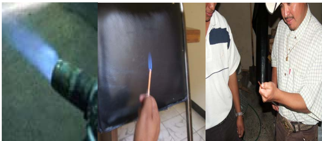
Figura No. 11. Flama del metano cuya coloración azul indica buena calidad del poder calorífico.
