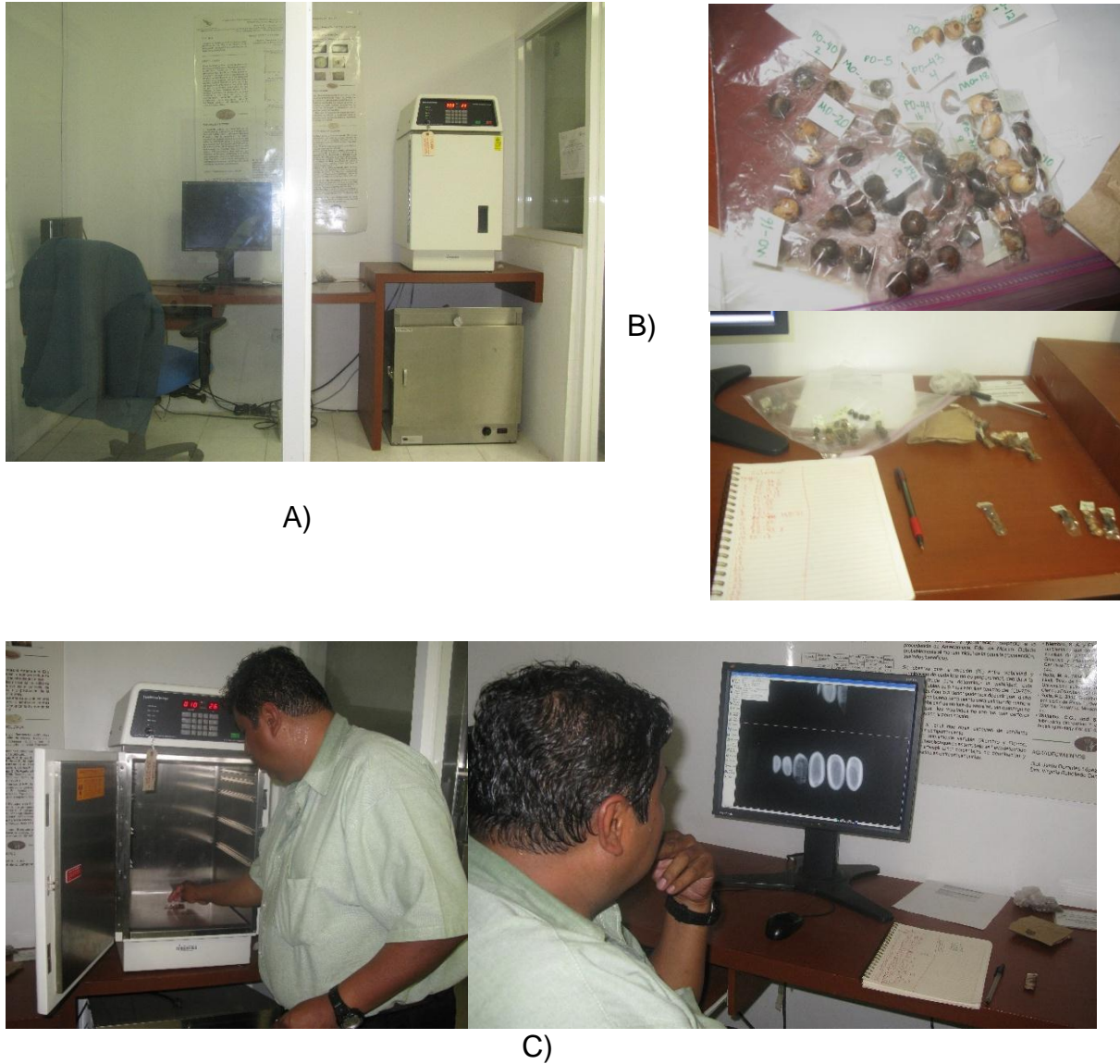
Figura 3. Secuencia en el uso del equipo Faxitron X-ray para la obtención de radiografías de semillas de Pinus culminicola Andresen et Beaman. A) Preparación del equipo y configuración, B) Control de las muestras de semillas, C) Toma de la radiografía. (Fotografía tomada por Celestino Flores López (A y B) y Virginia Rebolledo Camacho (C)).
