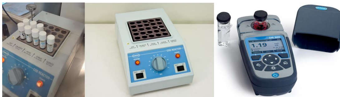
Figura 6. Reactor para determinación de la DQO y espectrofotómetro portátil DR 900, HACH®.
