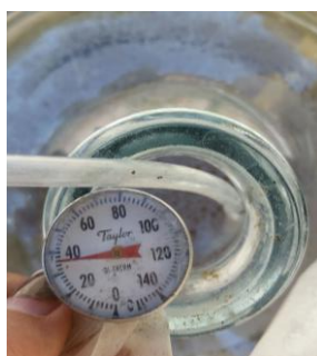
Figura 7. La toma de temperatura se realizó con un termómetro de aguja (Taylor, USA, Patente No. 5, 775,488).
