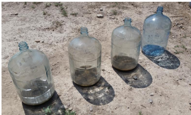
Figura 3. Fotografía de los fotobiorreactores de vidrio de 20L, como modelos para simulación de lagunas de alta tasa de producción de biomasa.
