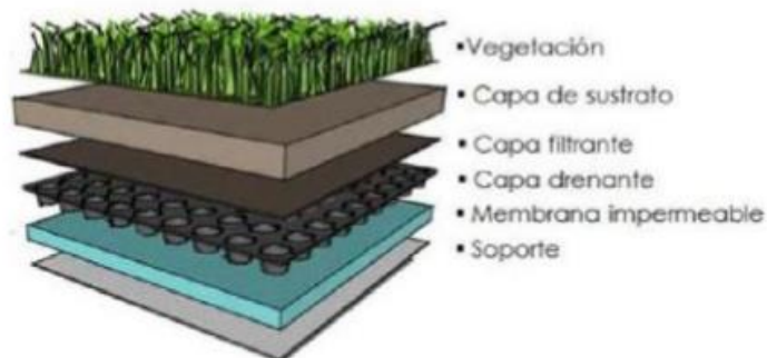
Figura 1. Componentes de un techo verde (de Rhodes-Valbuena, 2012).
