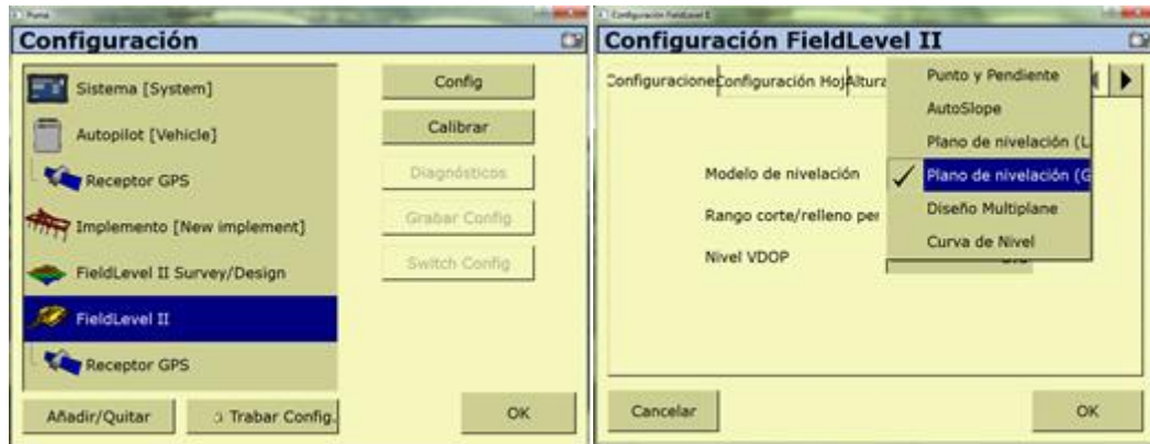
Figura C.3: a y b Configuración del FieldLevel II para plano de nivelación GPS.
