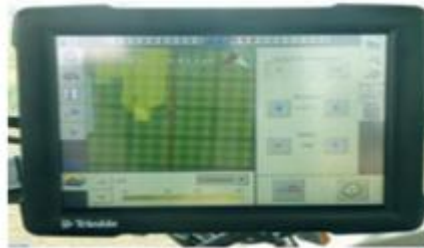
Figura 4.10 Pantalla FmX de Trimble para el control de los trabajos de agricultura de precisión (García et. al. , 2014).
