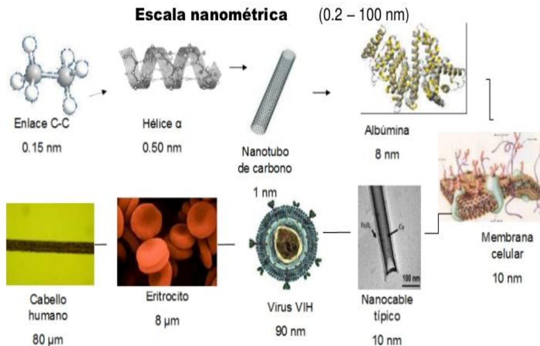
Figura 2. Dimensiones representativas de algunas formas existentes en sus varias escalas medidas en nanómetros (nm) y micrómetros ( \mu\text{m} ), para comparar el tamaño que representan las nanopartículas el cual varían entre 1 y 100 nm (Cebrián Candelera, 2011).
