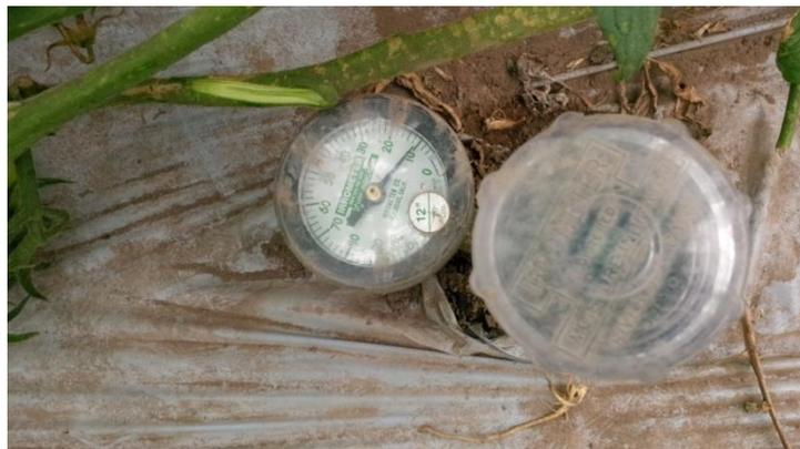
*Figura 23.* Tensiómetro de 12", colocado en el invernadero para monitorear la humedad en el suelo.
