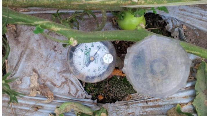
*Figura 22.* Tensiómetros de 6", colocado en el invernadero para monitorear la humedad del suelo.
