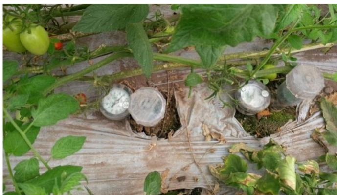
*Figura 24.* Tensiómetros de 6" y de 12" colocados en el invernadero para monitorear la humedad en el suelo.
