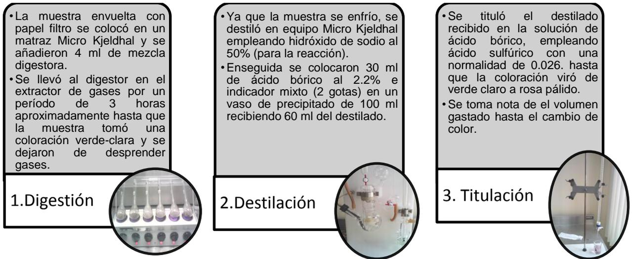
**Figura 21. Etapas para la determinación de proteínas.**
