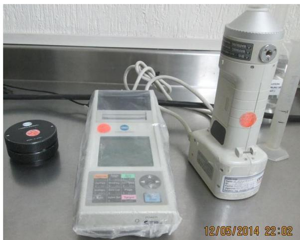
**Figura 20.** Colorímetro Konica Minolta CR-400 para determinación de color.
