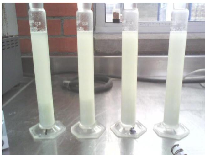
**Figura 16.** Determinación de sedimentación.
