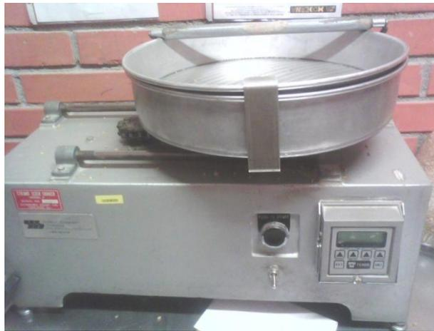
**Figura 14.** Strand Sizer Shaker para obtener el % de grano quebrado y chupado.
