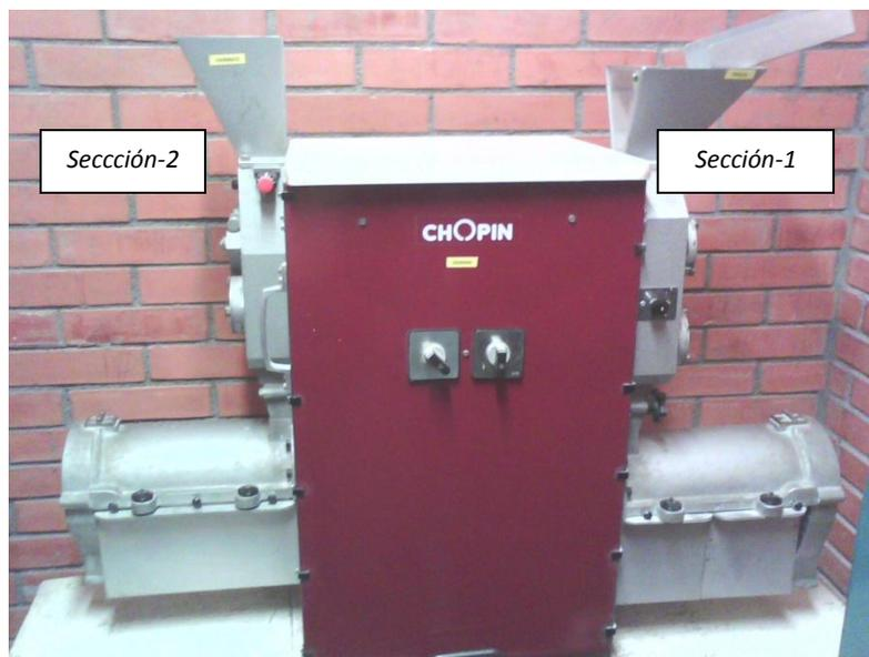
**Figura 15.** Molino experimental Chopin CD1. Sección 1 y 2.
