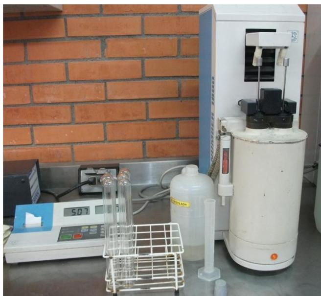
**Figura 18.** Equipo falling number Type 1800.
