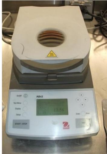
*Figura 24. Termobalanza Ohaus para determinación de humedad.*
