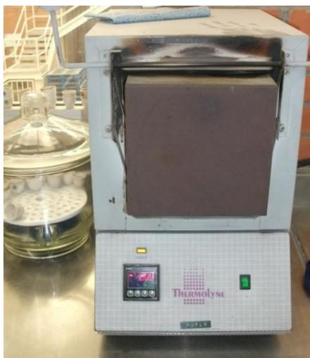
**Figura 19.** Mufla para la determinación de cenizas.
