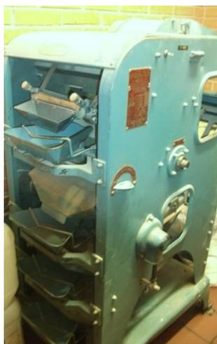
**Figura 10.** Carter Dockage Tester para limpieza de trigo
