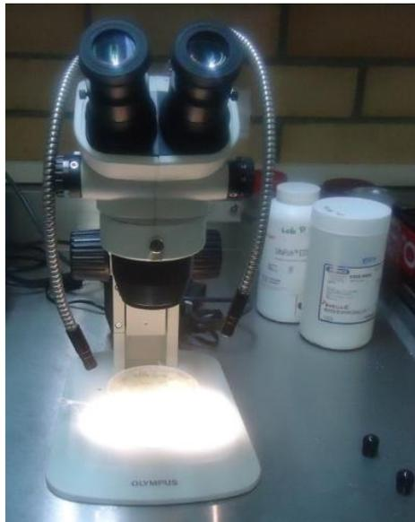
Figura. 7 Microscopio estereoscópico.
