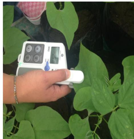
Figura 8. Medición de clorofila
