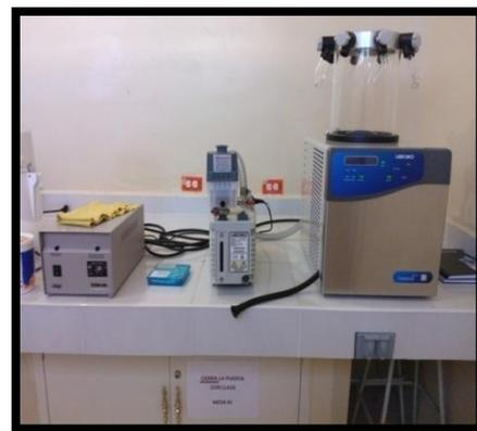
**Imagen 8.** Equipo de liofilización de la marca LABCONCO, modelo FreeZone 2.5 plus.
