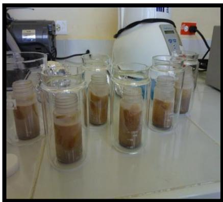
**Imagen 9.** Vasos de precipitado del equipo de liofilización, con frascos de plástico con muestra congelada a  $-80^{\circ}\text{C}$ .
