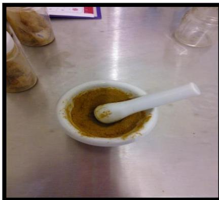
**Imagen 10.** Muestra triturada en capsula de porcelana después del proceso de liofilización.
