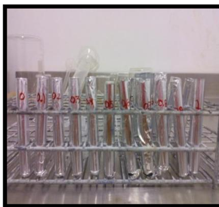
**Imagen 12.** Prueba de cuantificación de compuestos fenólicos.
