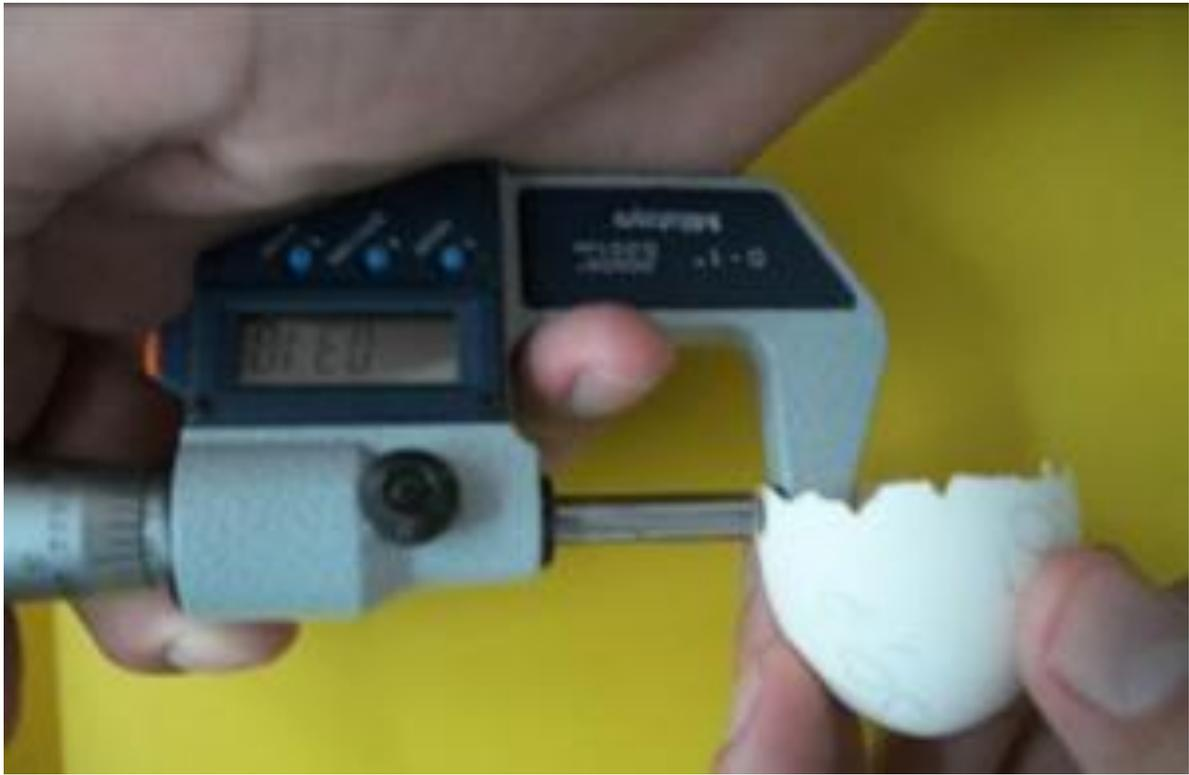
**Figura 15.** Determinación de grosor de cascarón mediante micrómetro (Abarca y Quintana, 2011).
