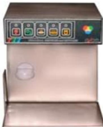
**Figura 13.** Espectrómetro para el cálculo de la coloración de yema (tss-york, s.f.).
