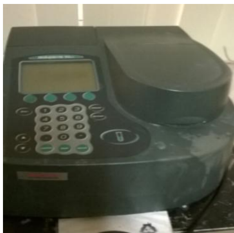
Figura 16. Espectrofotómetro implementado para cuantificación de fenoles y flavonoides.
