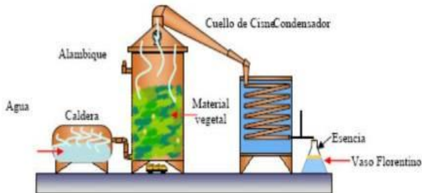
Figura 7. Destilación por arrastre de vapor.
