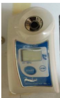
Figura 15. Refractómetro utilizado para medir el índice de refracción.
