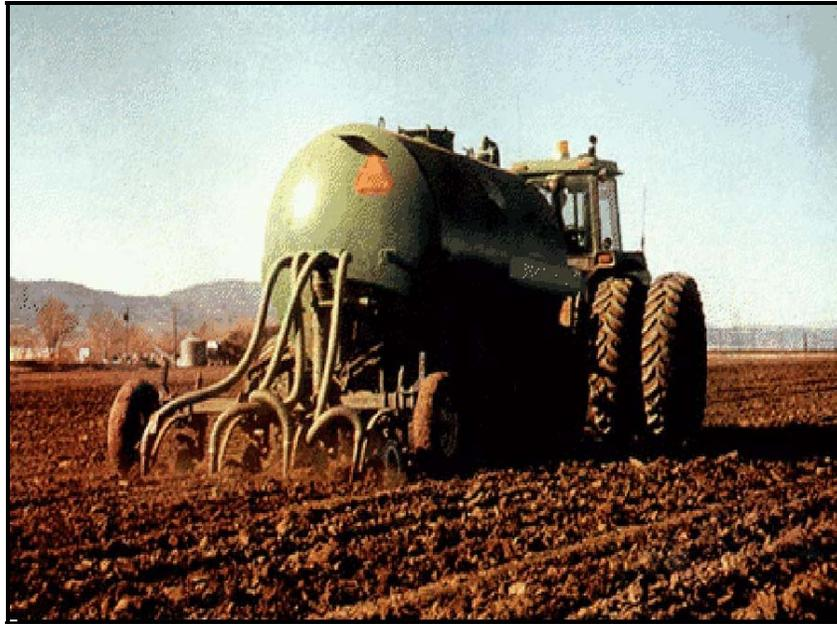
**Figura 2-5.** Tractor equipado con sistema de inyección de lodos.
