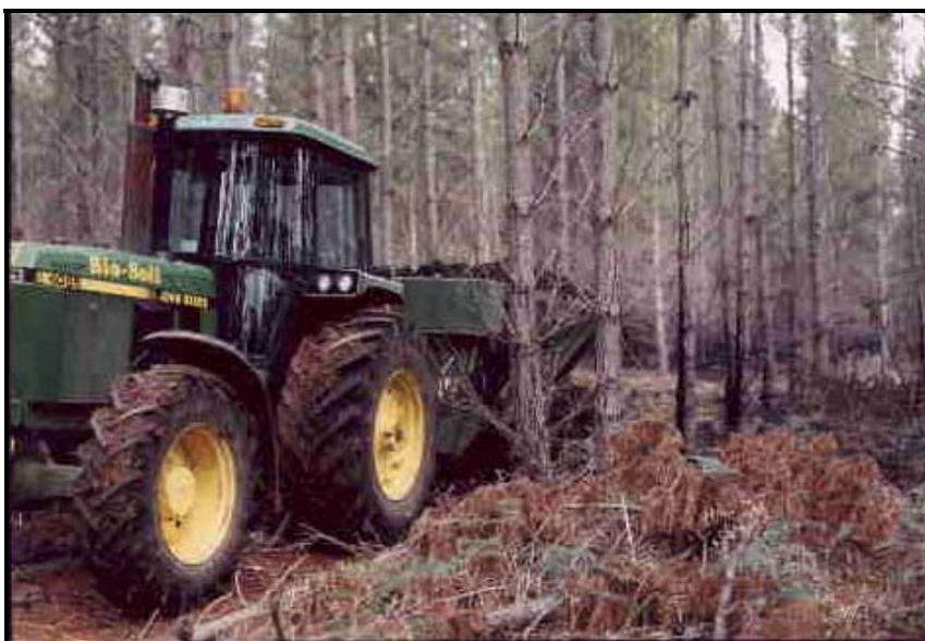
**Figura 2-3.** Aplicación de lodo deshidratado sobre terreno forestal.
