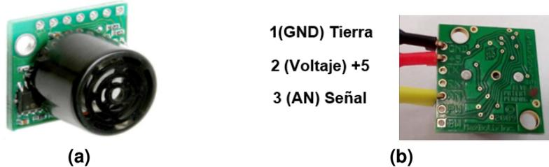
**Figura 3.5:** a) Sensor y b) conexiones del sensor LV-MaxSonar-EZ1.
