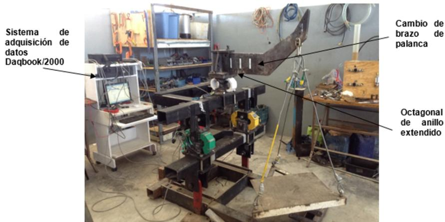
**Figura 4.41:** Materiales utilizados en la calibración del sensor OAE.
