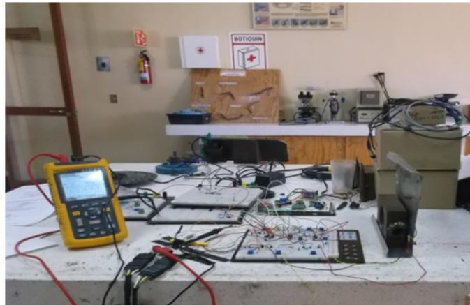
**Figura 4.11:** Materiales utilizados en la calibración del sensor de profundidad
