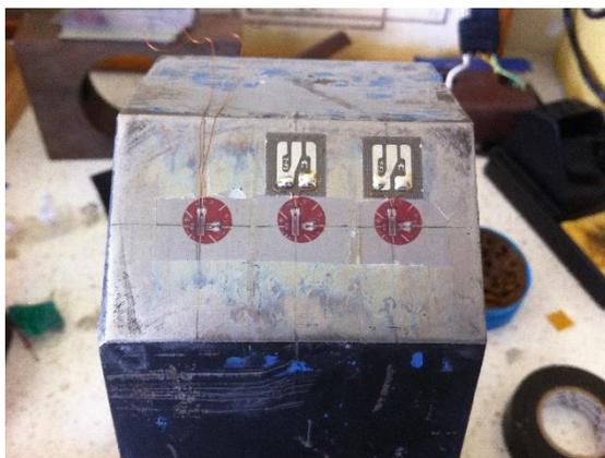
**Figura F3.** Colocación de las galgas extensiométricas en el octagonal extendido
