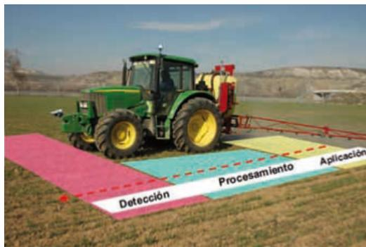
**Figura 2.14:** Sistema de tratamiento en tiempo real con sensor de vegetación situado delante del tractor.
