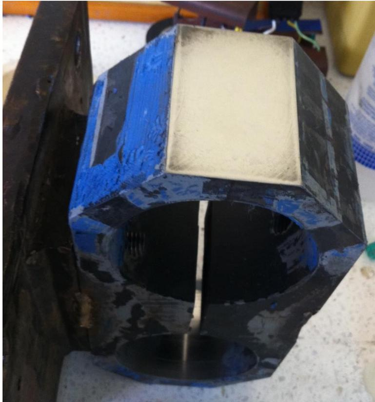
**Figura F1** Octagonal lijado listo para montaje de galgas extensiométricas
