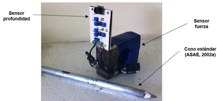
**Figura 4.2:** Penetrómetro integrado por sensor de fuerza, sensor de profundidad y cono.
