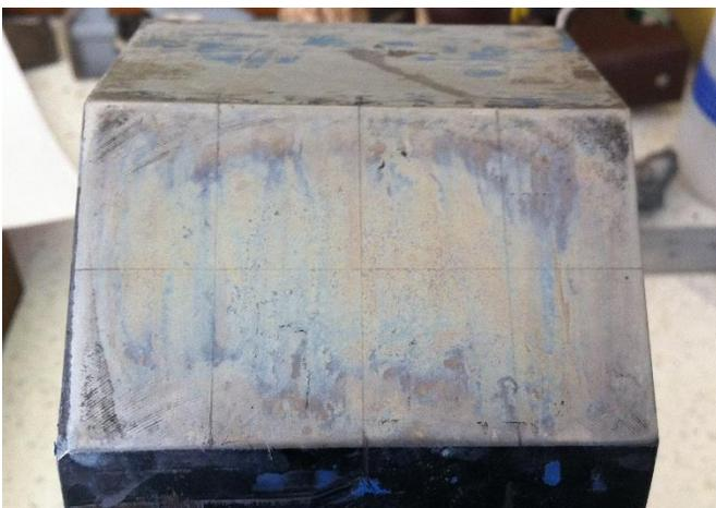
**Figura F2** líneas de posición de las galgas extensiométricas según el puente de Wheatstone
