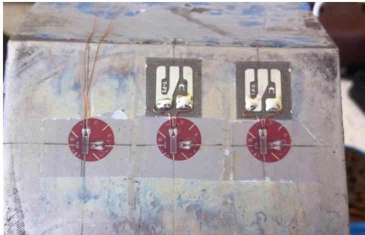
**Figura F5.** Colocación de conectores galga-cable.
