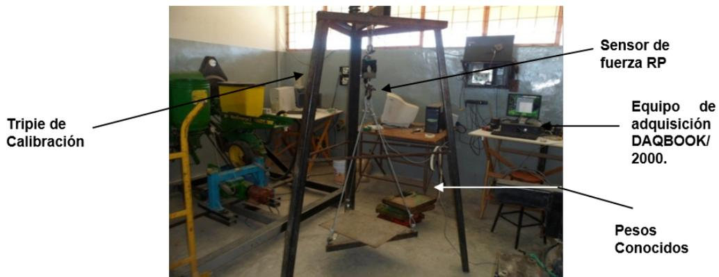
**Figura 4.7:** Materiales utilizados en la calibración del sensor de fuerza
