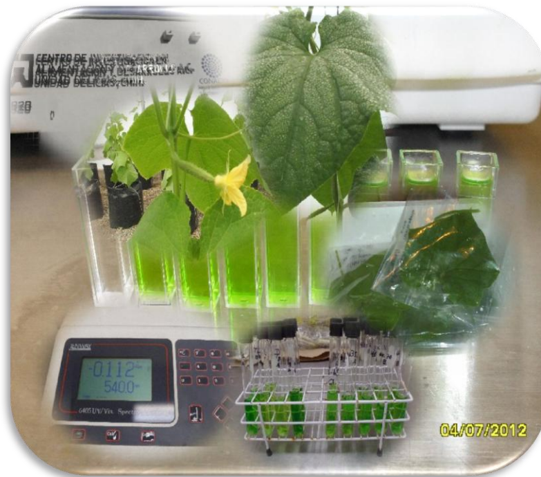
Figura 10. Cuantificación de pigmento clorofílico a y b en la hoja de pepino. En laboratorio de Fisiología y Nutrición vegetal del CIAD-Delicias, Chihuahua., con Espectrofotómetro VIS/UV (Wellburn, 1994).
