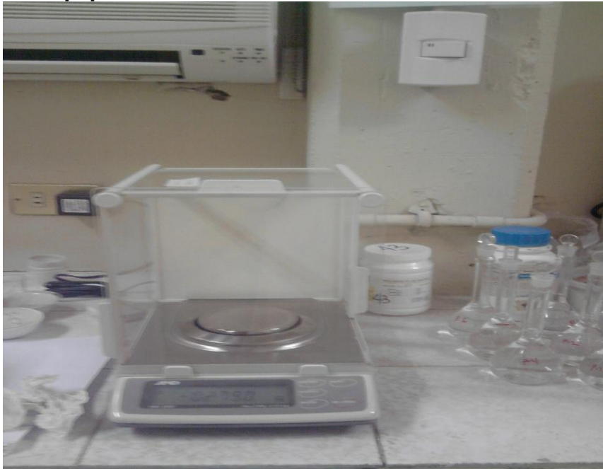
Ilustración 1 Balanza analítica: de precisión electrónica de la marca AND (modelo HR-200).
