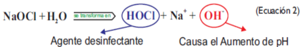
Figura 2.4. Representación sobre la acción química del hipoclorito de sodio en el agua.
