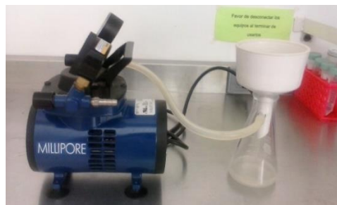
Figura 20. Filtración del jugo a través de una bomba de vacío.
