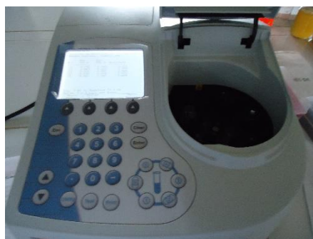
Figura 24. Espectrofotómetro en proceso de calibración para cuantificar ADN.
