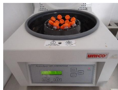
Figura 17. Separación de la biomasa y el extracto mediante una centrifugación.
