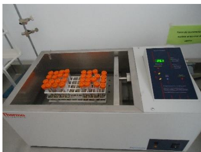
Figura 16. Baño maría para los diferentes tratamientos de tiempo y temperatura.
