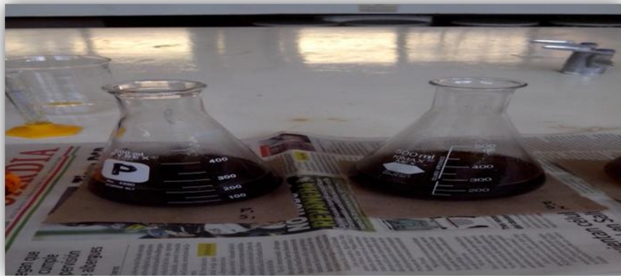
Figura 9. Color que muestra la solución después de la oxidación de la materia orgánica.
