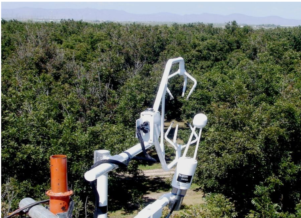
Figura 1. Anemómetro sónico tridimensional y analizador de vapor de agua y bióxido de carbono de sendero abierto. Sobre el dosel de la huerta de nogal pecanero en Zaragoza, Coahuila, México.
