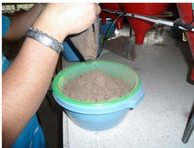
Figura 10. Embudo de Berlesse, cada uno con un kilo de suelo recolectado.
