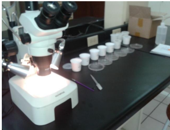
Figura 12. Estereoscopio para determinar la clasificación de la mesofauna.
