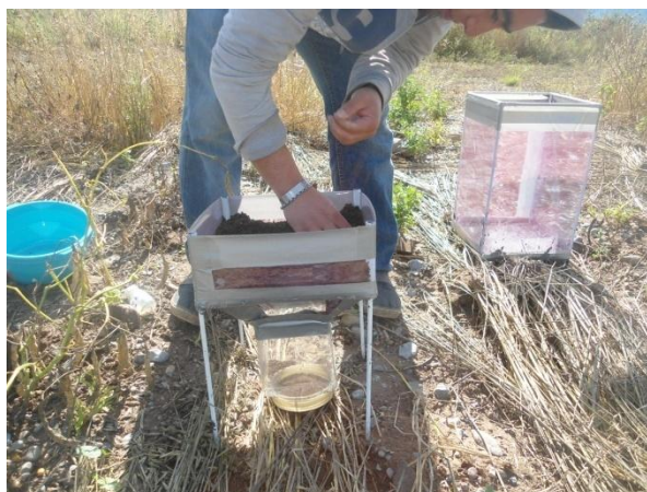
Figura 9. Segundo tamiz para la recolección de un kilo de tierra para el laboratorio.
