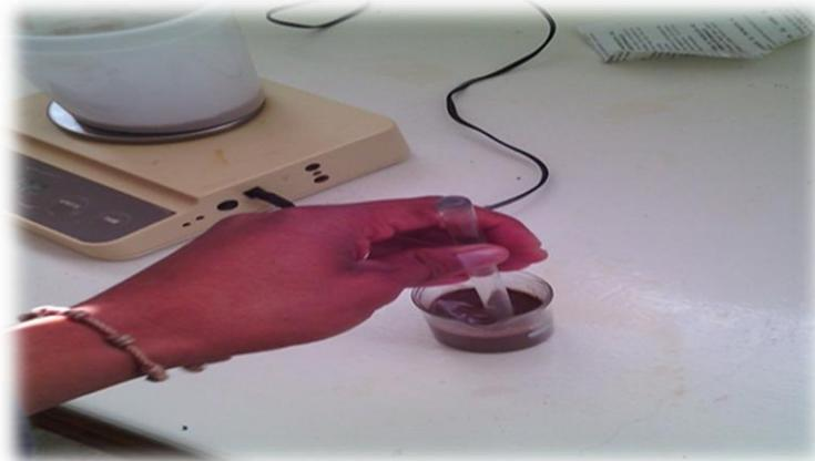
**Figura 3.14. Determinación de pH por el método potenciómetro**
