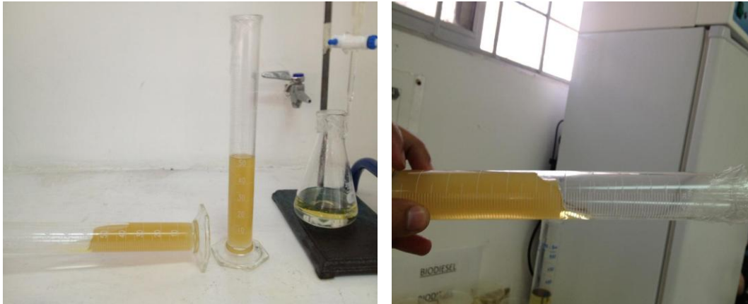
Figuras15 y 16.Gelificación presente en las muestras del ensayo con etóxido.
