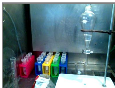
Figura 5. Extracción con acetato de etilo utilizando embudo de separación, que posteriormente se colocó en tubos cónicos de 50 mL para después ser evaporado hasta sequedad por arrastre con aire o nitrógeno.
