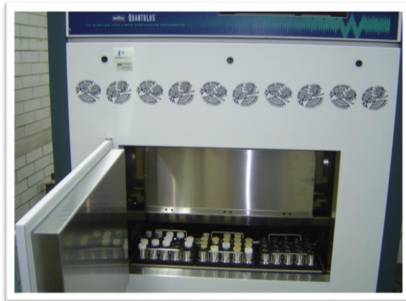
Figura 10. Espectrómetro de Centelleo Líquido de ultra bajo nivel Wallac Quantulus 1220
