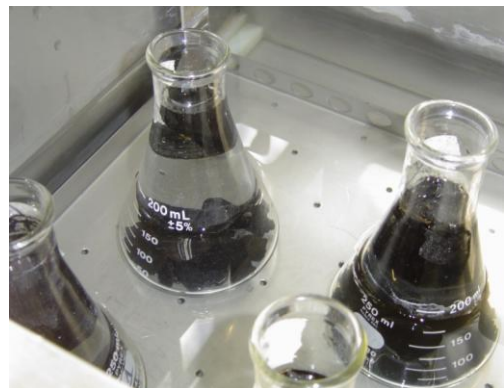
Figura 8. Método químico: eliminación de carbonatos y sustancias húmicas con ácidos y bases diluidos.
