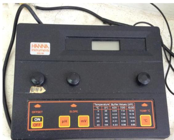
**Figura 3.7.1.2. Potenciómetro**
