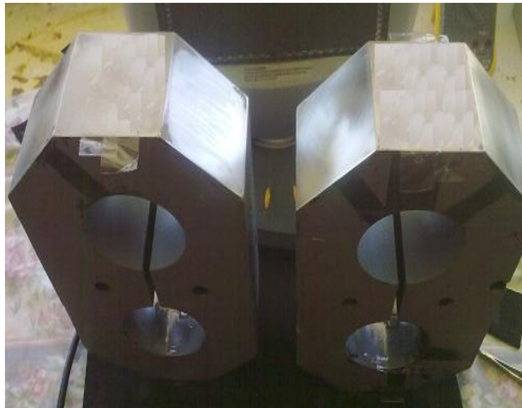
Figura B1. Octagonal lijado, listo para la colocación de las galgas.
