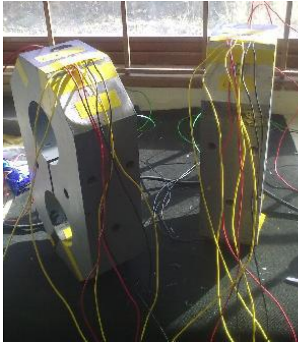
Figura 4.1.2. Galgas montadas y cableadas en el sensor octagonal extendido con capacidad de 40 kN.
