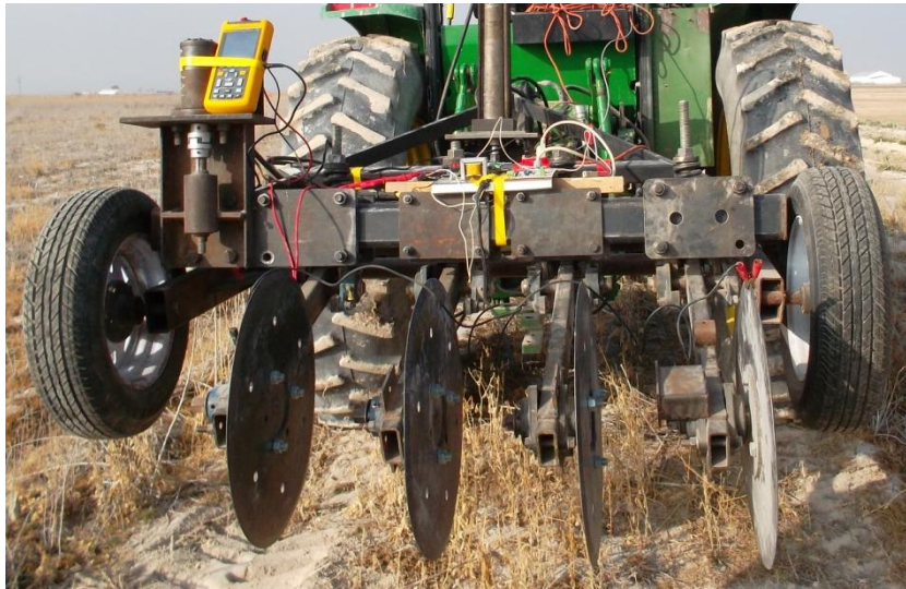
Fig. 4.13 Equipo utilizado para medir la conductividad eléctrica.
