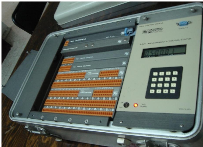
Figura 4. Registrador electrónico de datos “Datalogger” (modelo CR7 Campbell Sci., Inc., Logan, Utah, USA), donde se conectaron los thermocouples para el registro continuo de lecturas
