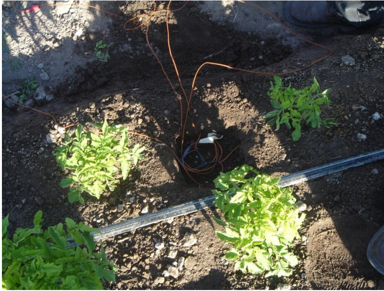
Figura 15. Colocación del thermocouple al centro de una cama de cada tratamiento a 2, 5, 10, 20 cm de profundidad.
