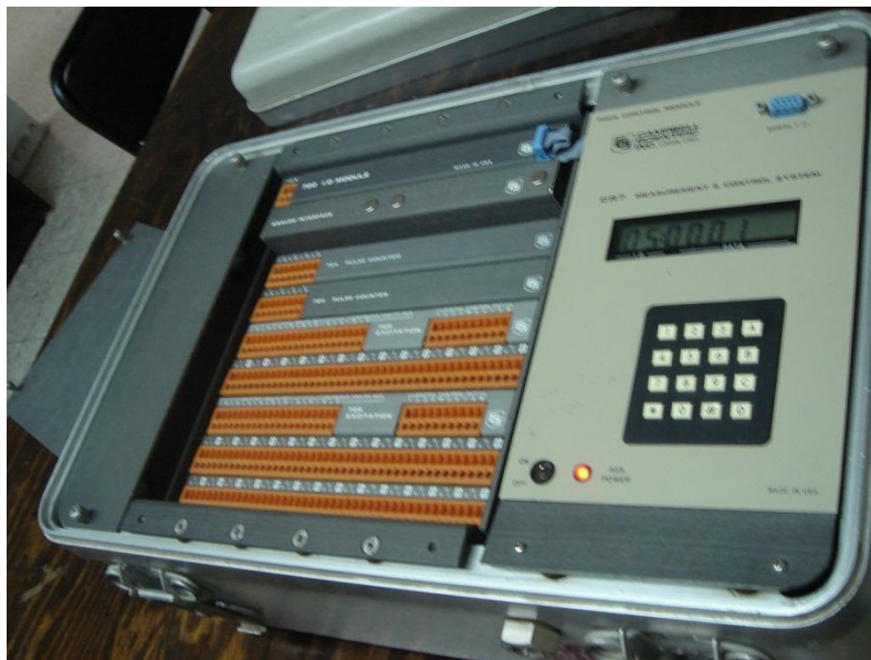
Figura 10. Registrador electrónico de datos “Datalogger” (modelo CR7 Campbell Sci., Inc., Logan, Utah, USA), donde se conectaron los Thermocouple para el registro continuo de lecturas.
