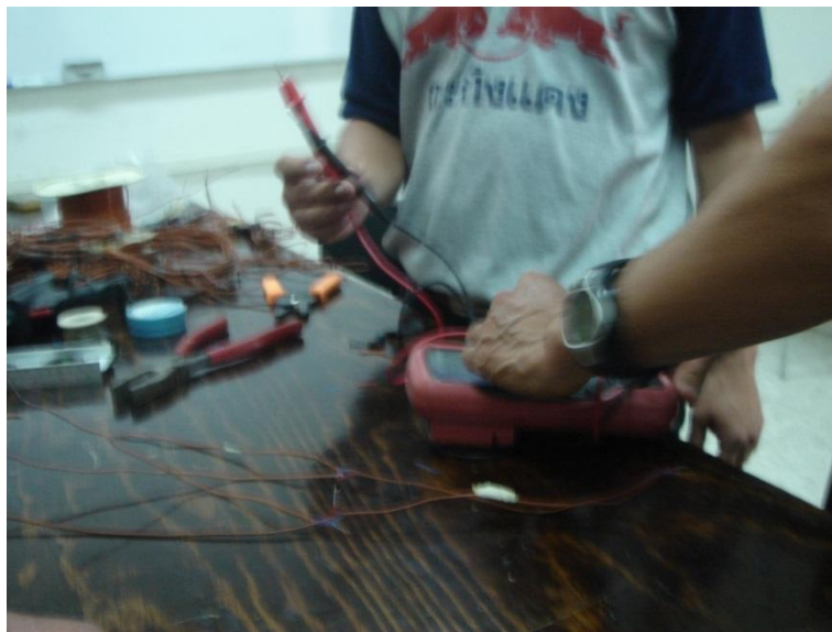
Figura 12. Prueba de continuidad de corriente con el voltímetro en los thermocouple.
