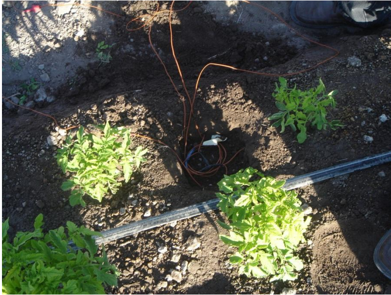
Figura 3. Colocación del thermocouple al centro de una cama de cada tratamiento a 5, cm de profundidad.
