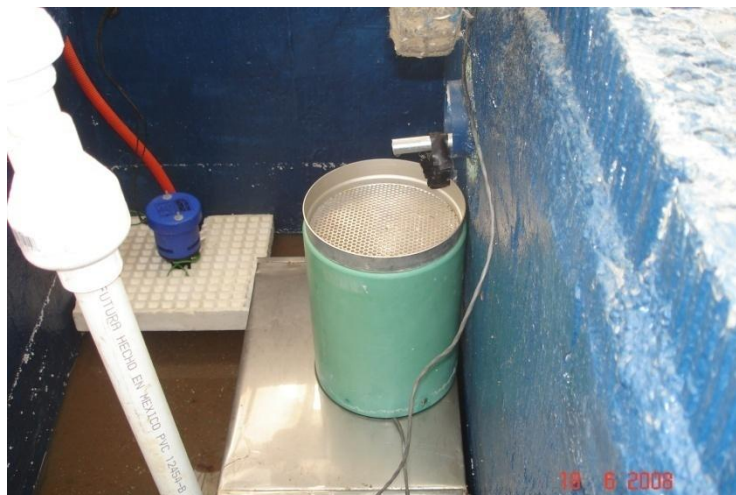
Figura 3.5 Pluviómetro electrónico modelo TR-5251 de Texas Electronics, inc., para el aforo en el tratamiento uno (T1).
