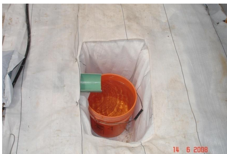
Figura 3.6 Captación del agua de riego drenado en los tratamientos dos (T2) y tres (T3), para el aforo manual.
