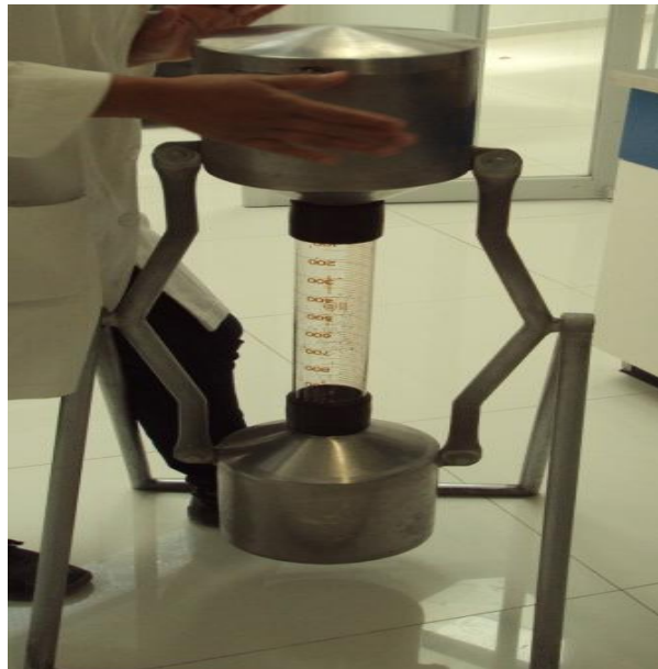
Figura 14 Panvolunómetro con semillas de nabo
