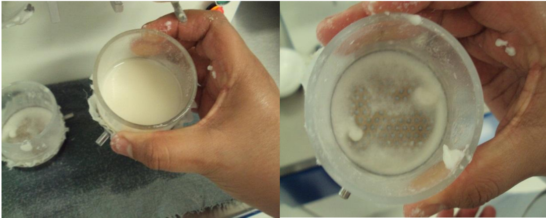
Figura 21 Muestras de harina sin gluten. Revelan la ausencia de gluten por no haber podido pasar por las mallas del Glutomatic o por haber pasado muy rápido.
