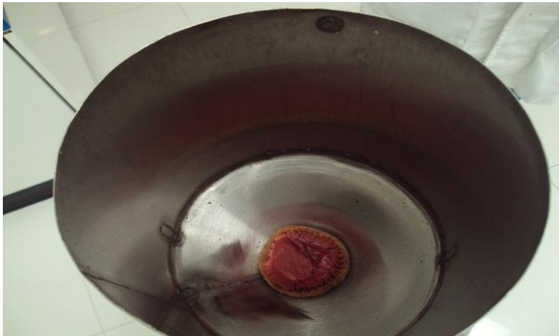
Figura 15 Compartimento del panvolunómetro donde se coloca el pan para medir su volumen
