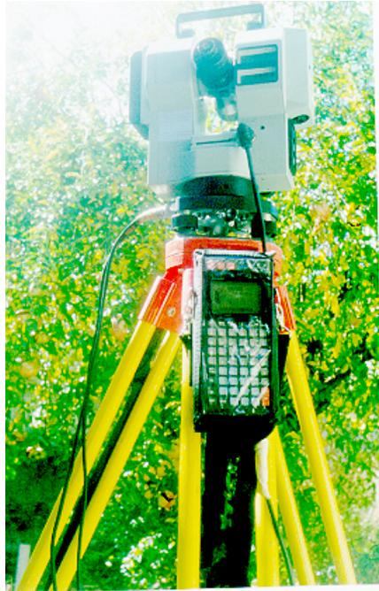
Figura 14.- Colector Electronico PSION HC-110 en interfase con Estación Total
