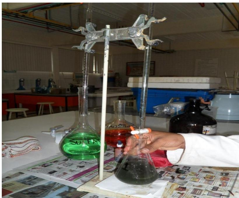
Figura 17. Titulación de las muestras con sulfato ferroso
