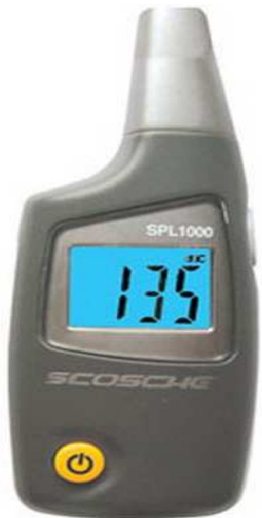
Figura 7. Spl-1000f scosche. Medidor de decibeles.
