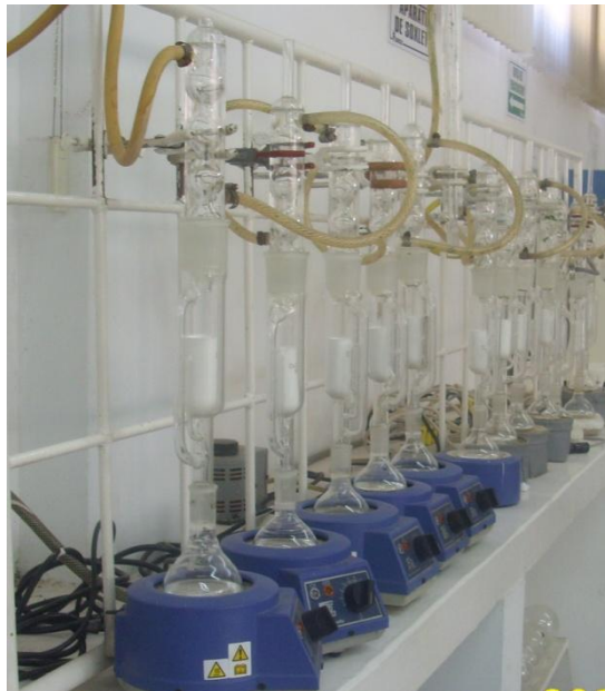
Figura 3.1 Extracción de grasa cruda por método Soxhlet
