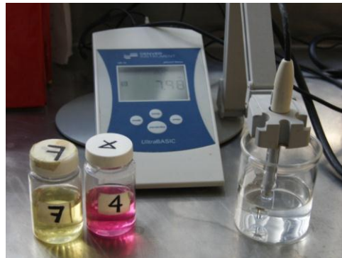
Figura 29. Potenciómetro y solución buffer 4 y 7 utilizadas para su ajuste.
