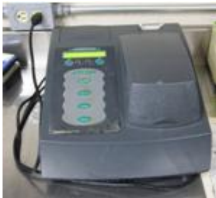
Figura 19. Espectrofotómetro utilizado para la determinación colorimétrica.
