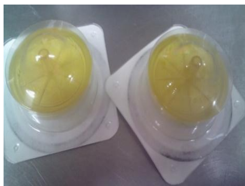
Figura 30. Filtros Puradisc utilizados para la filtración de AIA.
