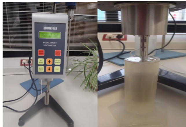
Figura 9. Viscosímetro digital empleado para analizar las propiedades reológicas de las películas comestibles.
