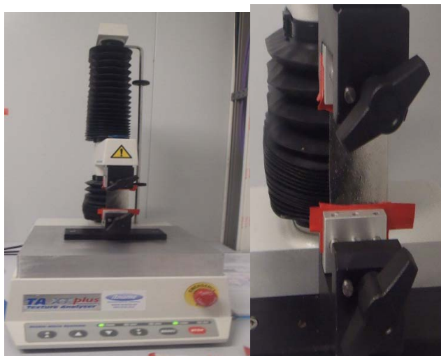
Figura 7. Texturómetro TA-XT plus empleado para análisis de propiedades mecánicas de películas comestibles.
