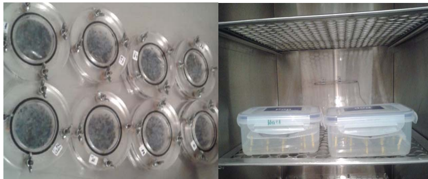
Figura 13. Celdas de permeabilidad utilizadas y cajas herméticas con celdas en estufa de secado a 20°C
