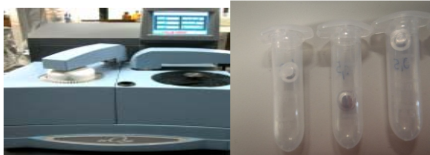
Figura 8. Calorímetro de barrido diferencial TA Instruments Modelo. DSC Q y capsulas de aluminio conteniendo las muestras de películas comestibles.
