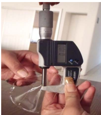
Figura 15. Micrómetro digital empleado para medir el espesor de las películas comestibles.
