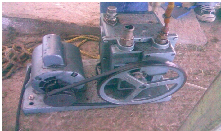
Figura 2. Bomba naso gástrica utilizada para extraer liquido ruminal.
