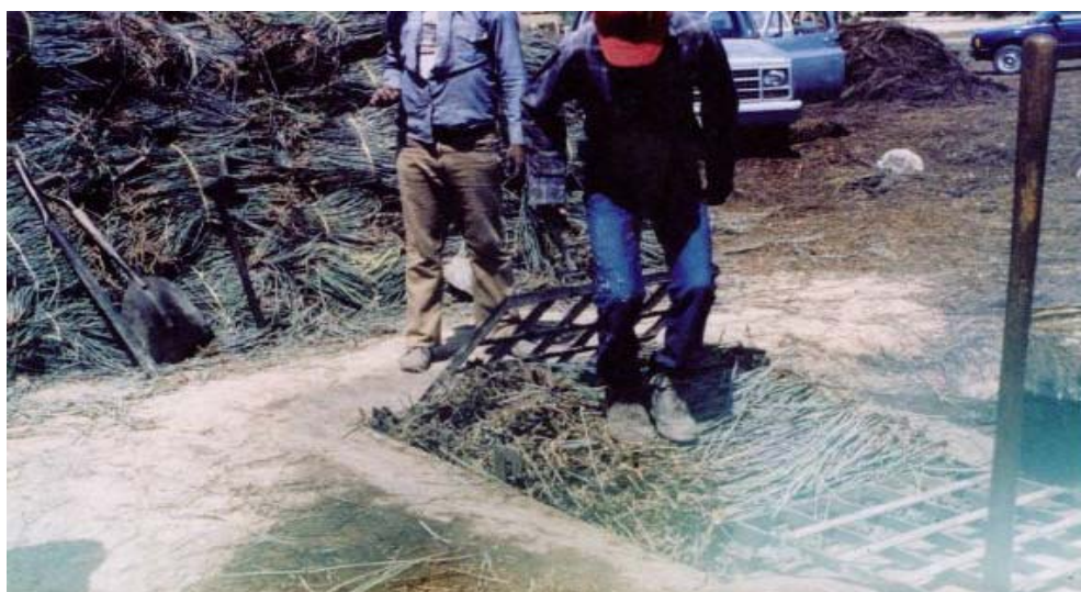
FIGURA 5. Acomodo de la candelilla en la paila y cargada al nivel requerido
