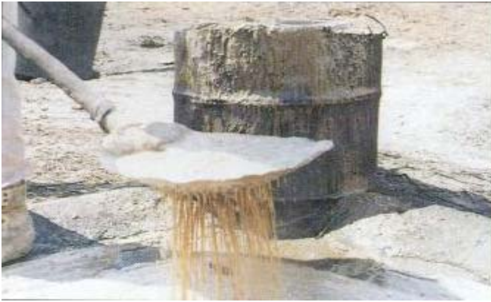
FIGURA 8. Herramienta utilizada para la colecta de espuma (Espumador)
