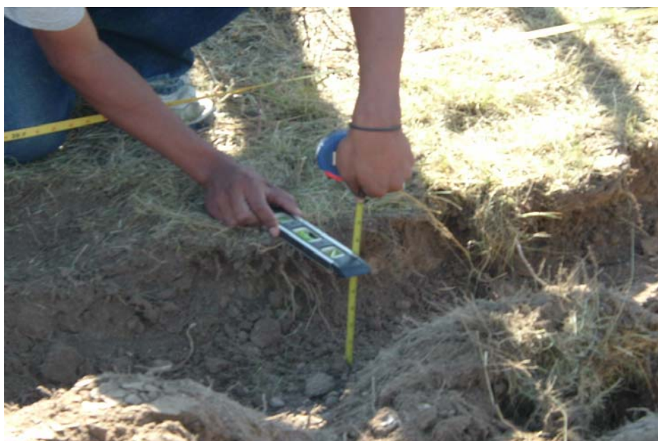
Fig. 3.10. Determinación de profundidad de trabajo.
