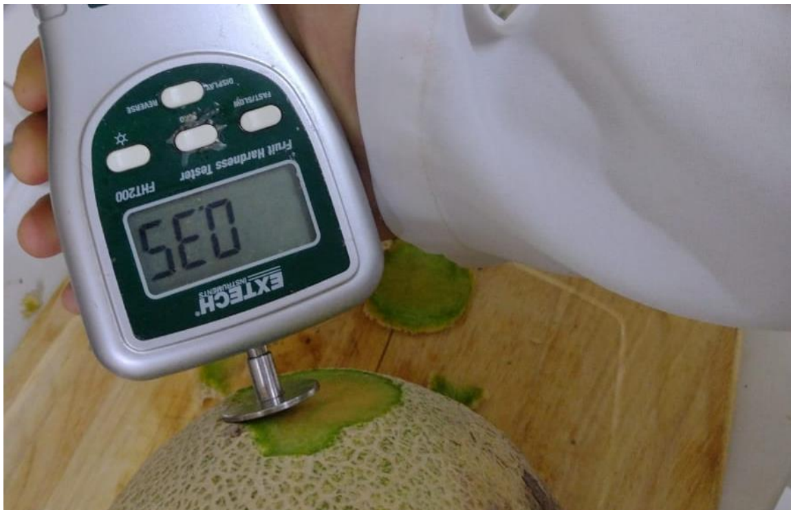
Figura 10. Uso de penetrometro para la determinación de firmeza
