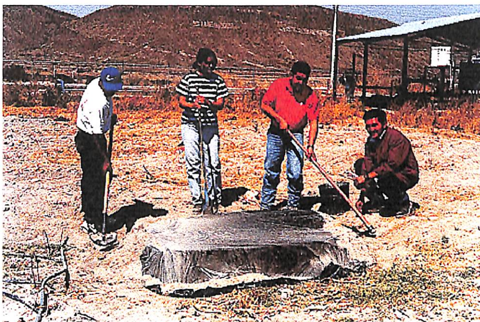
Figura 1 Preparación del terreno para determinar la Capacidad de Campo, por medio del método de campo.
