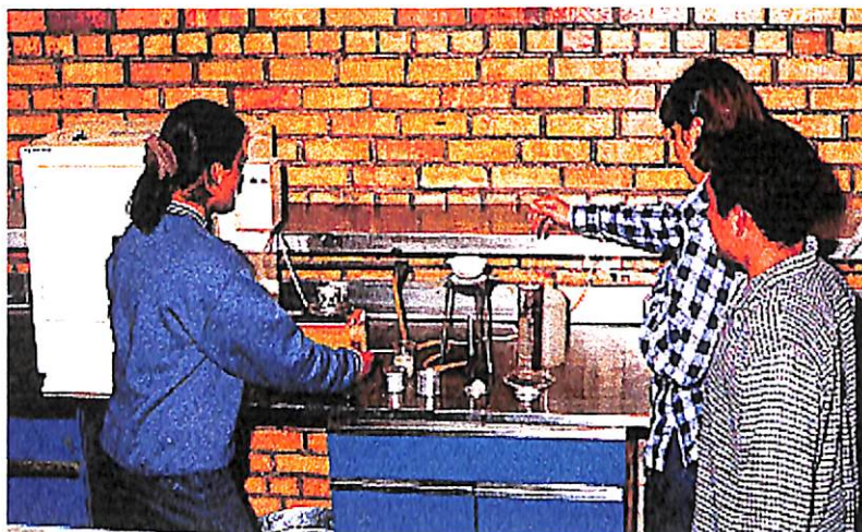
Figura 5 Determinación de la Densidad Aparente, por el método de la Parafina.
