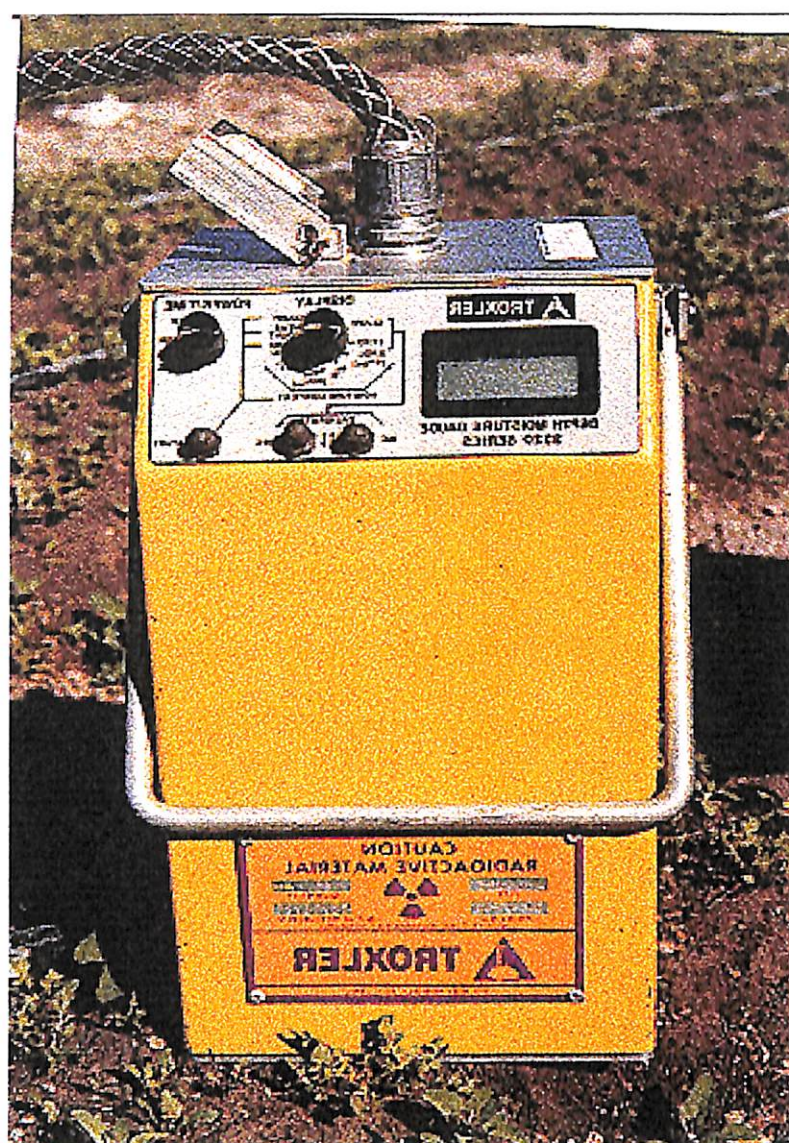
Figura 8 Dispersor de Neutrones, para la medición de la humedad del suelo.
