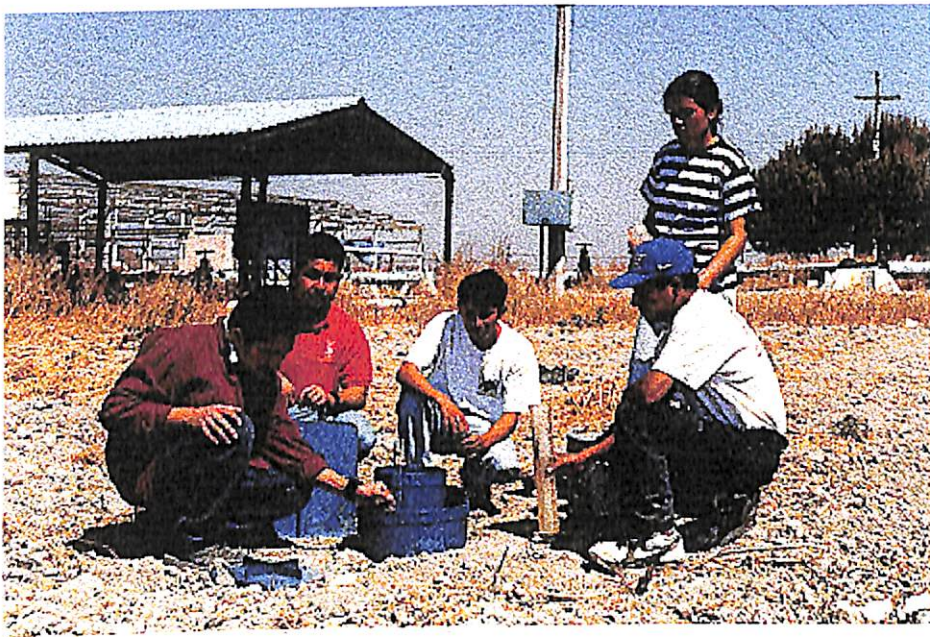
Figura 10 Método de los Cilindros Infiltrómetros, para calcular la velocidad de Infiltración.
