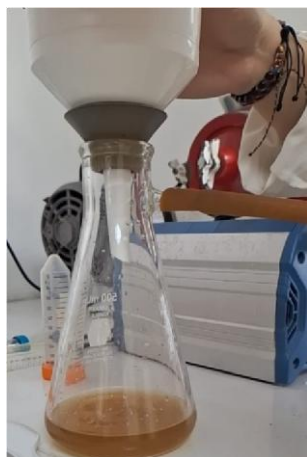
FIGURA 11. Sistema de filtración con matraz Kitasato y bomba al vacío empleando la determinación de biomasa húmeda
