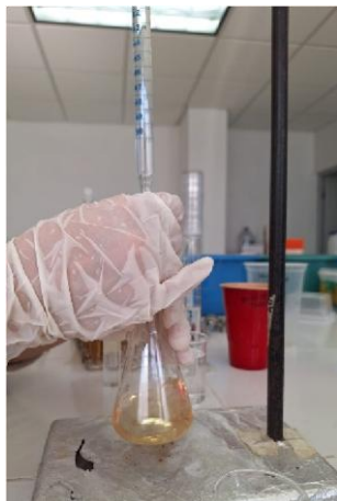
FIGURA 8. Proceso de titulación de la muestra de kéfir con NaOH para la determinación de acidez titulable
