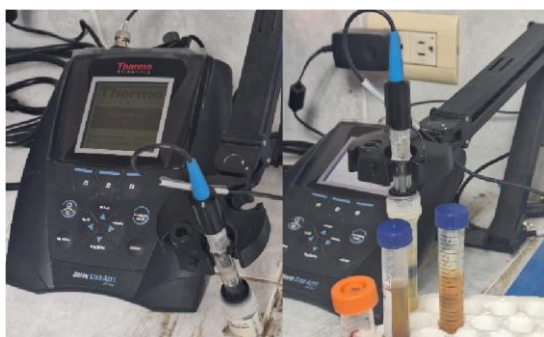
FIGURA 6. Medición del pH del fermentado de kéfir utilizando un potenciómetro digital
