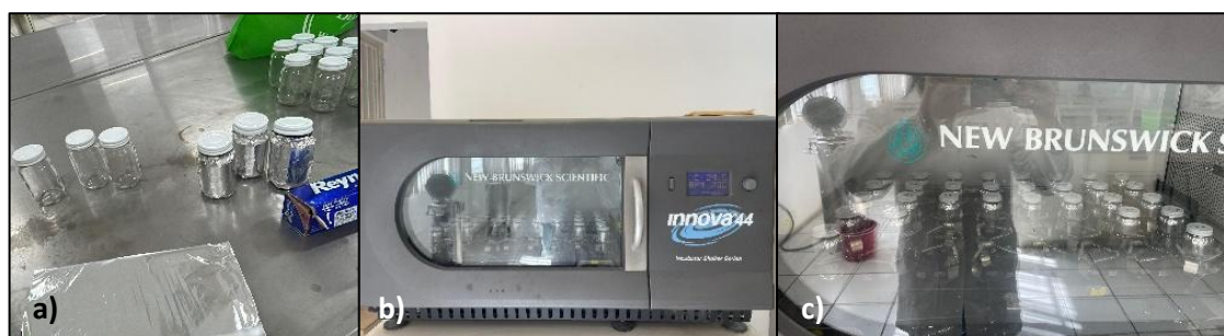
Figura 3.4.1. a)muestras reservadas en frascos de materia seca; b)equipo Shaker; c)muestras colocadas en el shaker
